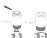
Термоэлектрический привод VR1123 снабжен пластиковой фиксирующей шайбой, которая служит для удобства монтажа привода на клапан и для принудительного поддержания актуатора в открытом состоянии. После монтажа привода на клапан и перед подачей напряжения фиксирующую шайбу необходимо снять.
