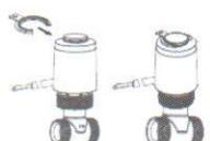
Для принудительного поддержания привода в открытом положении, вставьте фиксирующую шайбу обратно в паз колпака.
